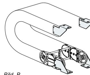
Bild. B Fixierung der Energieführungskette nach außen. (Bild B)
